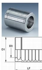
Универсальная обжимная муфта 1SN/2SN (гильза или кольцо) предназначена для опрессовки фитингов на рукав высокого давления типов EN853 1SN и EN853 2SN. Для обжимки РВД такими гильзами не требуется зачистка шланга перед опрессовкой специальным оборудованием.
